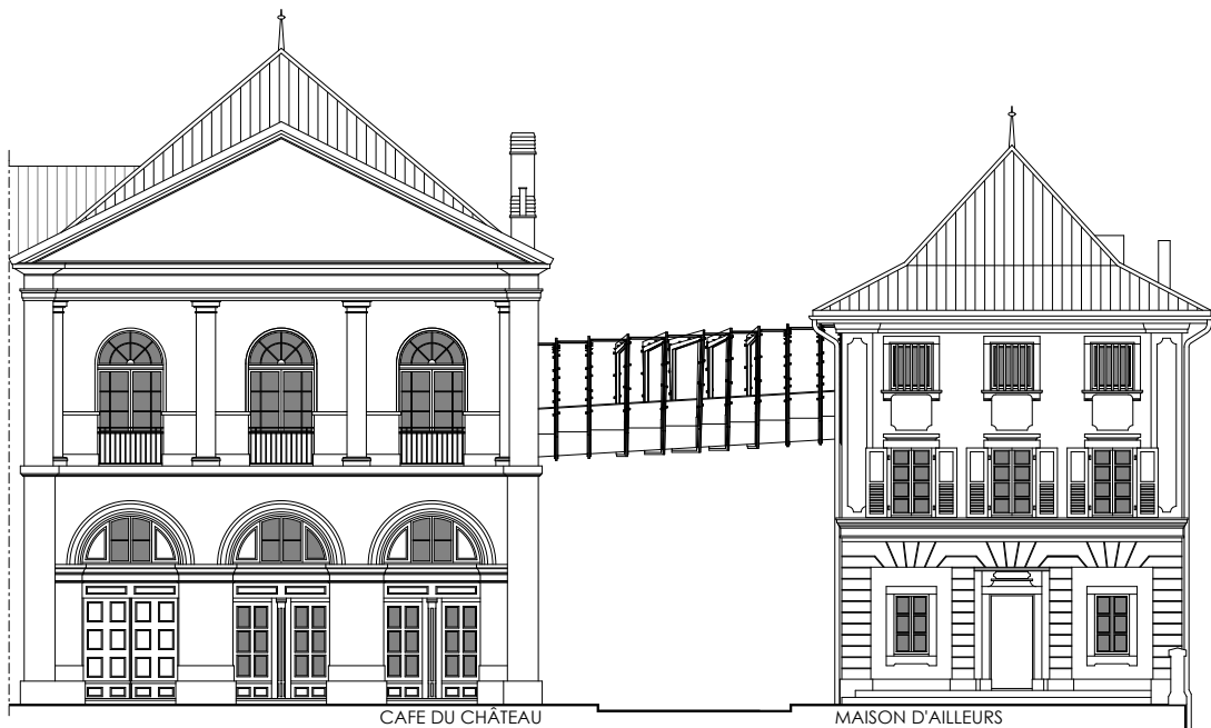
FACADE SUD - PASSERELLE DE LIAISON
