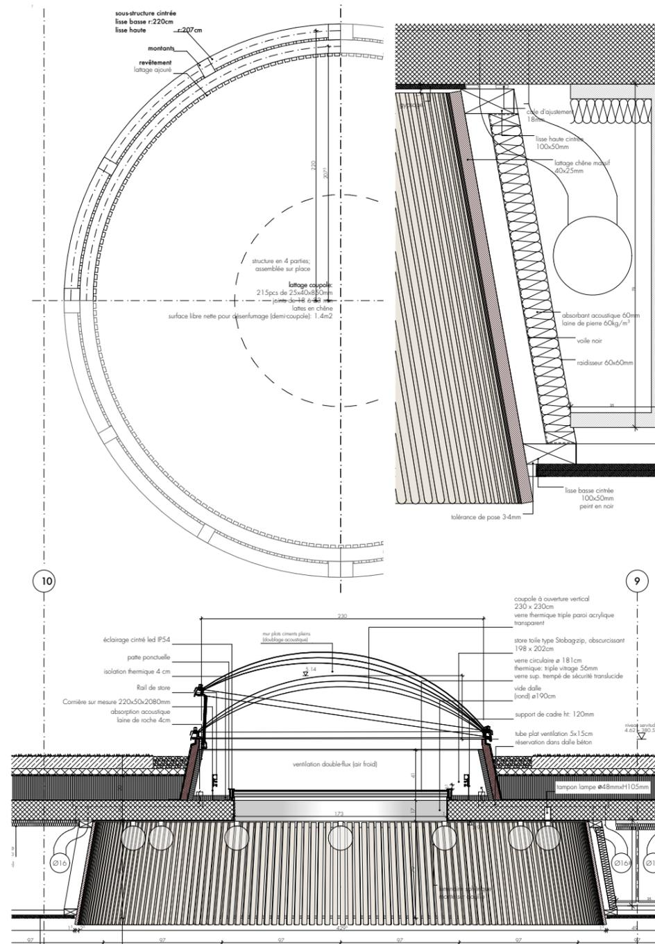
Le travail de la toiture de la chapelle cherche à augmenter la hauteur d'étage, restreinte par les droits de vue des immeubles donnant sur la cour, par un allègement de l'épaisseur du plafond entre les poutres structurales. Les formes rondes ainsi découpées amplifient la descente de la lumière naturelle dans l'espace comme des abat-jour géants.
