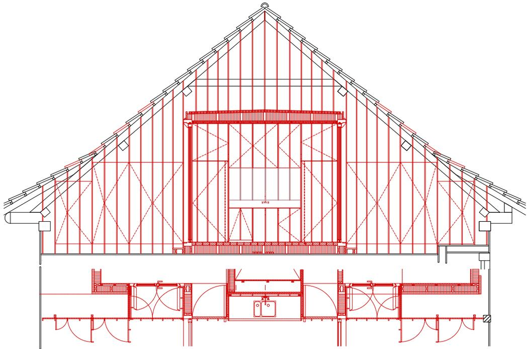
Elévation intérieure de la façade à couvre-joint - 1:100
